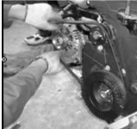
۲. ژنراتور را فشار داده و کشش تسمه را شل کرده و سپس تسمه و پولی و اتر پمپ را پیاده کنید.
