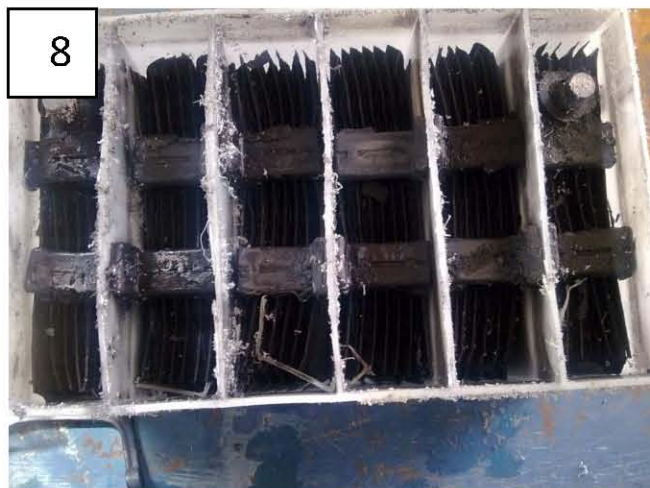
شکل ۸- سیاه شدن صفحات باتری و صفحه جداکننده صفحات (separator)
