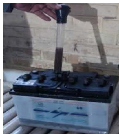
شکل ۶- تغییر رنگ الکترولیت به همراه افزایش غلظت الکترولیت به عنوان یکی از علائم اورشارژ
