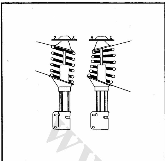
قسمت پایین استرات به سگدست و قسمت بالای آن به بدنه خودرو متصل می‌شود و فنر حلقی بین نشیمنگاه‌های بالایی (در پوش) و پایینی (نعلبکی فنر) قرار می‌گیرد. بسیاری از سازندگان خودرو نشیمنگاه‌های فنر را بصورت خارج از مرکز تعییه می‌کنند به همین جهت در موقع نصب و تعویض استرات باید دقت کرد تا نشیمنگاه بالایی درست نصب نشود فنر شکم داده و موجب ایجاد صدا، کشیده شدن خودرو به یک طرف و فرسایش زود هنگام استرات و اتصال بالای آن می‌گردد.
