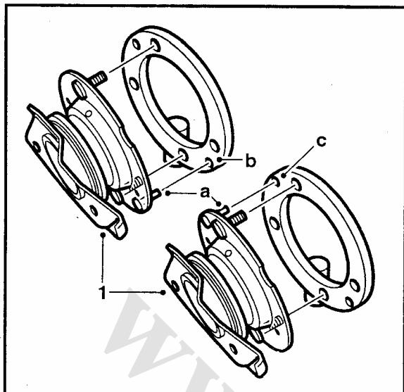
۱-صفه بالایی مجموعه فنر و کمک فنر روبروی صفحه بالایی ابراز جمع‌کننده فنر قرار دهید و پین (a) بر روی پشتبند را در سوراخ (b) یا (c) قرار دهید.
