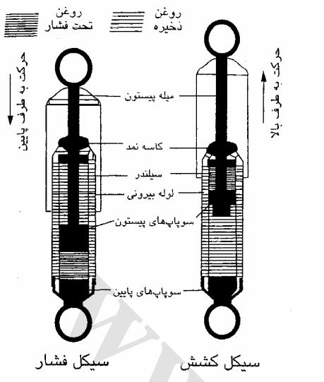
مقدار این نیرو به سرعت حرکت پیستون و اندازه و تعداد سوراخ‌های آن بستگی دارد. کمک فنر نسبت به سرعت باز و بسته شدن حساس است یعنی هر چه سریعتر باز و بسته شود نیروی عکس العمل آن بزرگتر است به دلیل این ویژگی کمک فنر با شرایط جاده خود را منطبق می‌کند. در نتیجه موارد زیر را کاهش می‌دهد:
