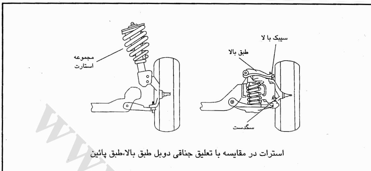
ضرورت تولید خودروهای سبکتر با مصرف سوخت کمتر موجب روی آوردن سازندگان خودرو به ساختن خودروهایی شده است که محور محرک آنها در جلو قرار دارد. در این گونه خودروها سیستم‌های تعليق جنائي به دليل محدوديت فضا قابل استفاده نيستند و استرات‌ات جايگزين آنها شده است.
