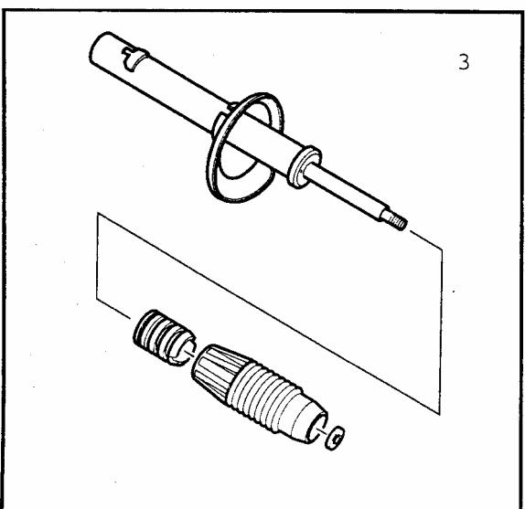
۳-ضربه‌گیر، گردگیر، لاستیکی و واشر را بر روی کمک فنر سوار کرده و آنرا در مجموعه فنر قرار دهید.
