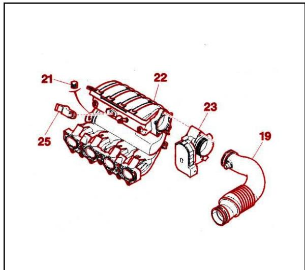
مدار تغذیه هوای ورودی :
