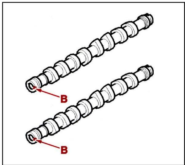
بادامکها و یاتاقانها را با روغن موتور رو غنکاری نمایید .
