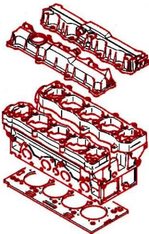
سرسیلندر از جنس آلیاژ آلومینیوم می باشد و قطر داخلی و خارجی نشیمنگاه واشر فنر سوپاپها در این موتور با موتور TU5JP4 ، متفاوت است . مقدار باز شدن سوپاپها در این موتور متغیر است .
