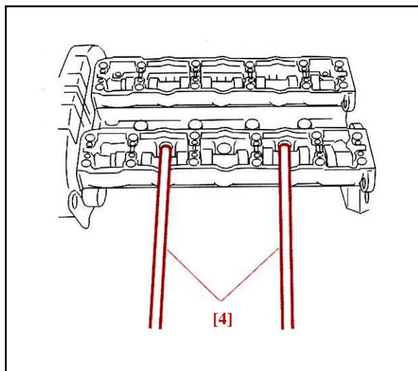
توسط ابزار مخصوص (4) (کد اختصاصی ۲۴۴.۸۰۰.۸) ، به دقت سرسیلندر را کج کرده و جدا نمایید دقت کنید که کاور تایمینگ آسیب نبیند. سرسیلندر و واشر مربوطه را باز نمایید.
