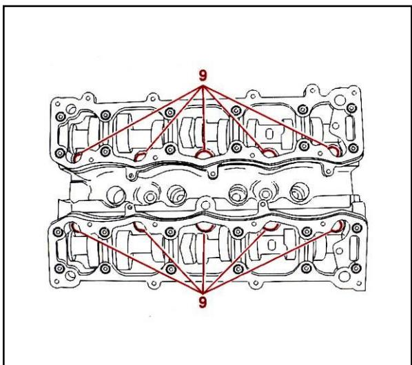
پیچ های سرسیلندر (9) را به تدریج و به روش حلزونی از سمت بیرون (دو طرف سرسیلندر) به سمت داخل شل کنید و سپس باز کنید.
