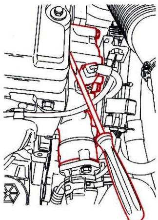
هوزینگ ترموموستات خودروهای پژو ۴۰۵، پارس و سمند با موتور TU5، از جنس آلمینیومی می‌باشد (برخلاف ۲۰۶ که از نوع کائوچوئی می‌باشد) و ترموموستات از هوزینگ آن (برخلاف ۲۰۶) قابل جدا شدن می‌شود.
