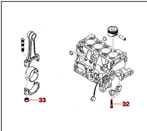
**پیچهای کپه های ثابت و متحرک و میل لنگ**
