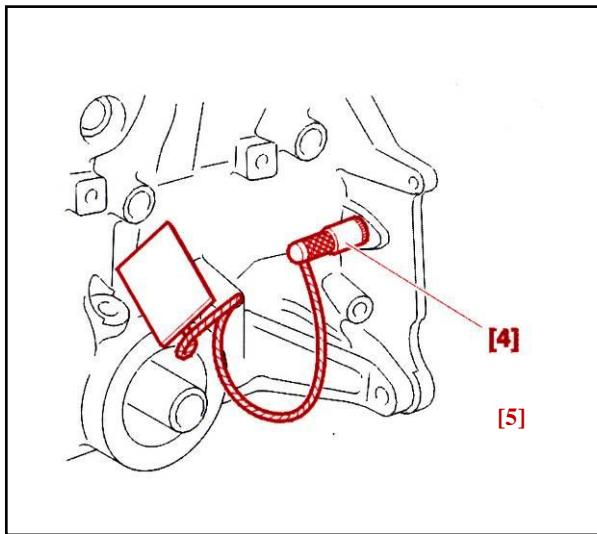
ابزار مخصوص قفل کن فلاپیول [5] (جزء کیت ابزار تعمیر موtor با کااختصاصی ۲۴۴۱۱۰۷) را مطابق شکل جا بزنید.
