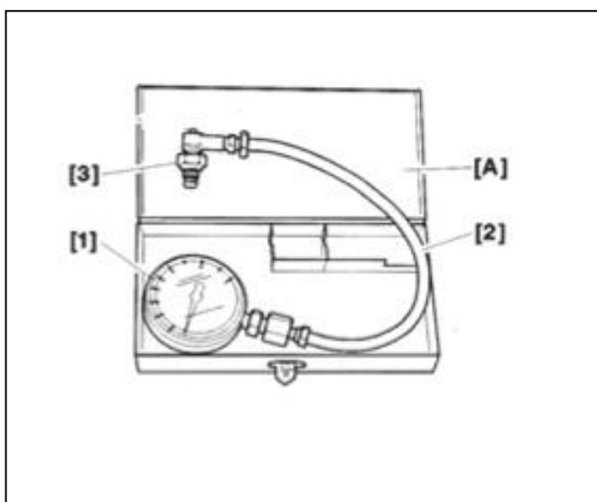
**اندازه گیری فشار روغن**
