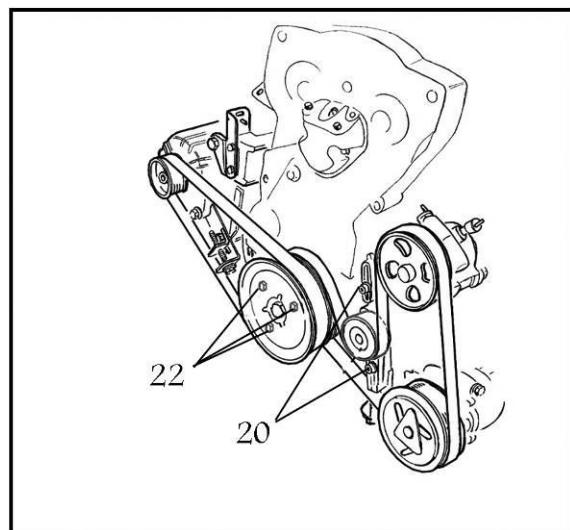
گشتاور پیچ تسمه سفت کن (20):
