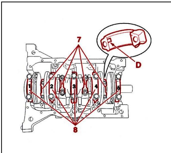
توجه : در موقع حازدن کپه متحرک دقت کنید که شیار یاتاقان (D) کپه متحرک را مقابل شیار یاتاقان روی کپه شاتون قرار گیرد .
