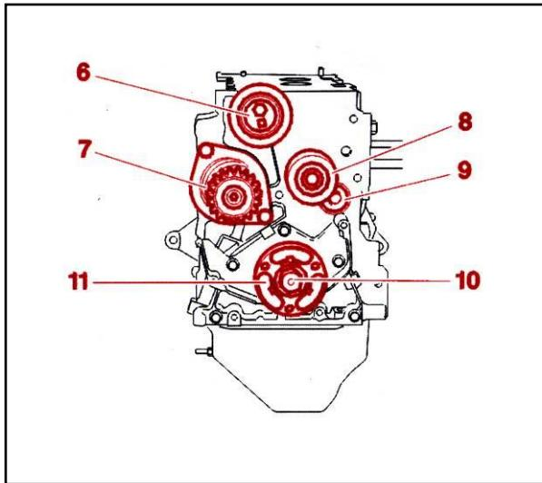
غلتك تسمه سفت کن (6)، واتر پمپ (7)، بلبرینگ تسمه سفت کن (8)، کورکن مجاری روغن (9)، پیچ شماره (10) و چرخدنده سر میل لنگ (11) را باز نمایید.
