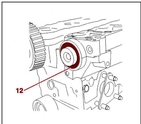
با استفاده از ابزار مخصوص شماره [3] (کد اختصاصی ۲۴۴۱۵۰۱۱) ، کاسه نمدهای میل سوپاپ (12) را جا بزنید .
