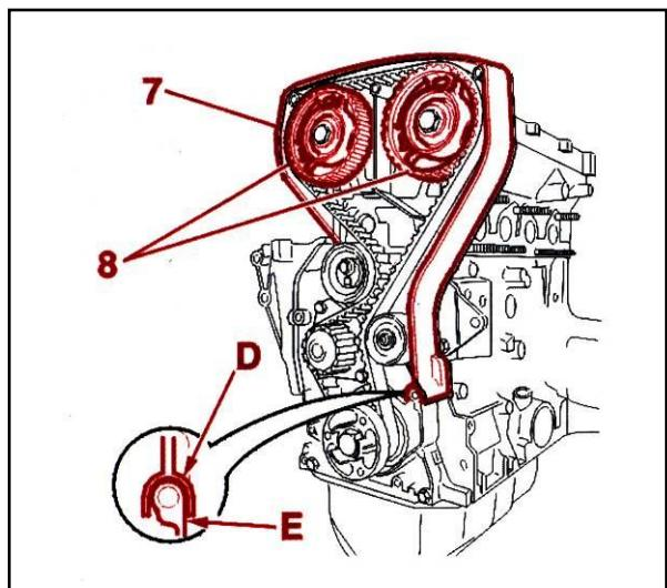
قب تسمه تایم را جا بزنید (7) . زبانه (D) قاب تسمه تایم را با شکاف صفحه عایق زیر آن به درستی درگیر کنید. (E) دنده میل سوپاپ را ببندید . (8)
