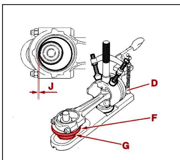
مطابق شکل رو برو، ابتدا پیستون را بر روی زیر پیستونی [2] (کداختصاصی ۲۴۴۲۴۰۳) قرار دهید و با استفاده از مجموعه جازن [1] (کداختصاصی ۲۴۴۱۲۰۰۴) و دسته جازن گژین پین [4] (کداختصاصی ۲۴۴۱۲۰۰۸) و جازن گزن پین [3] (کداختصاصی ۲۴۴۱۲۰۰۹) پیستون را در محل خود تنظیم کنید. با استفاده از پیچ های تنظیم (E) و محکم نمودن گیره (A) و ثابت نمودن آن با پین (D)، پیستون را در محل خود ثابت کنید.
