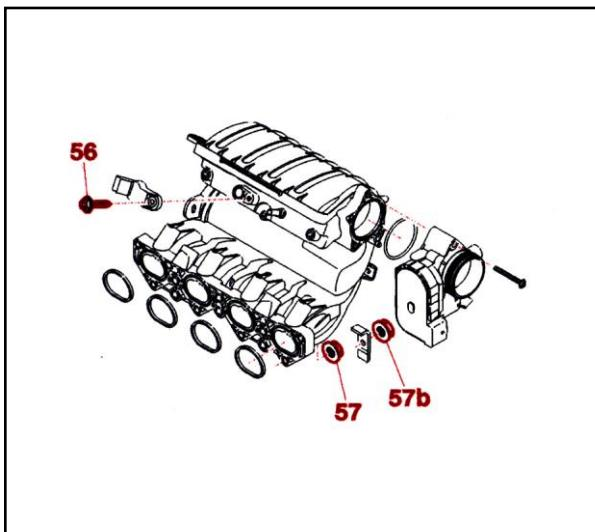
توجه: در صورت باز نمودن منیفولد هوای ورودی ، واشرهای اتصال منیفولد هوای به سرسیلندر (اورینگهای نشان داده شده در شکل) باید تعویض گردند.
