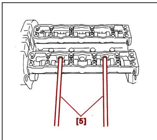
سرسیلندر را با استفاده از ابزار جابجا نمودن سرسیلندر [5] (کد اختصاصی ۲۴۴۰۸۰۰۸) ، از محل خود جدا نمایید. دقیق نمایید که در هنگام برداشتن سرسیلندر ، به قاب تسمه تایم صدمه ای وارد نشود. واشر سرسیلندر را جدا نمایید و محل نشست واشر و سیلندر و سرسیلندر را تمیز نمایید.
