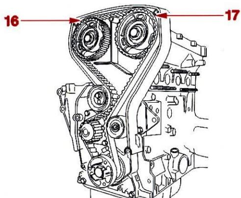
کشش تسمه تایم را با استفاده از تسمه سفت کن و ابزار مخصوص اندازه گیری کشش تسمه تایم SEEM105.5 تنظیم کنید.
