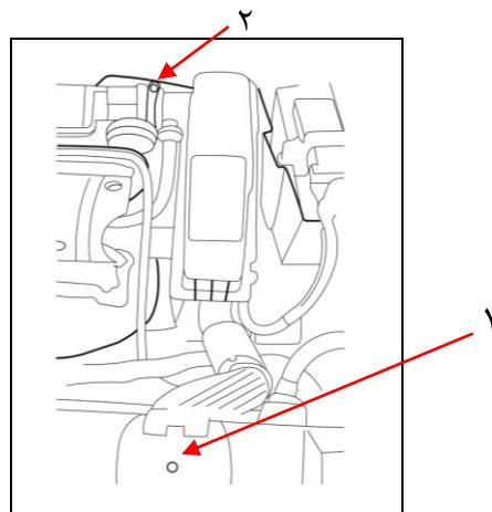
۵- مجموعه هواکش را با باز کردن پیچهای آن پیچ (۱) و پیچ دو سو (۲) خارج نمایید.
