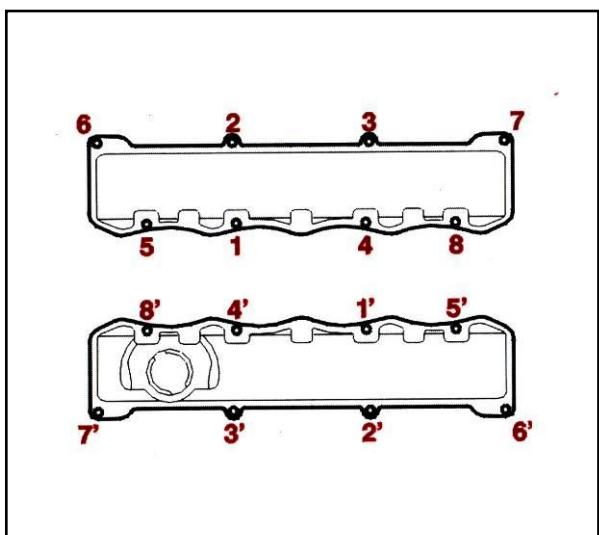
قالپاق سوپاپ را با واشر نو مطابق ترتیب بستن پیچها در شکل سفت کنید. (گشتاور سفت کردن ۷/۰ دکانیوتن متر می باشد)
