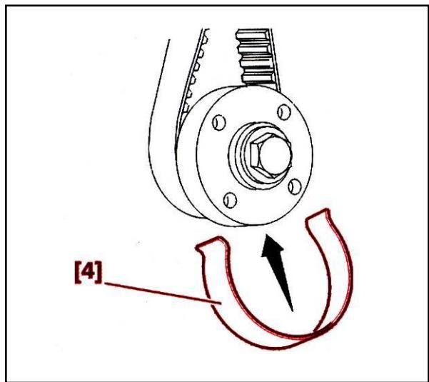
برای ثابت نگهداشتن تسمه تایم بر روی دنده سر میل
