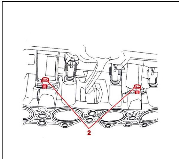
پیچ های اتصال ریل سوخت (2) به منیفولد را باز کنید و ریل سوخت را جدا نمایید.
