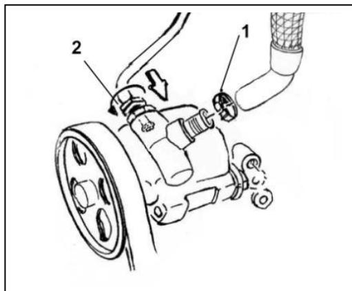
۱۲- بست فلزی شلیلگ پمپ هیدرولیک(۱) را جدا و شیلنگ را از پمپ جدا نمایید سپس لوله فشار قوی پمپ(۲) را جدا نمایید.
