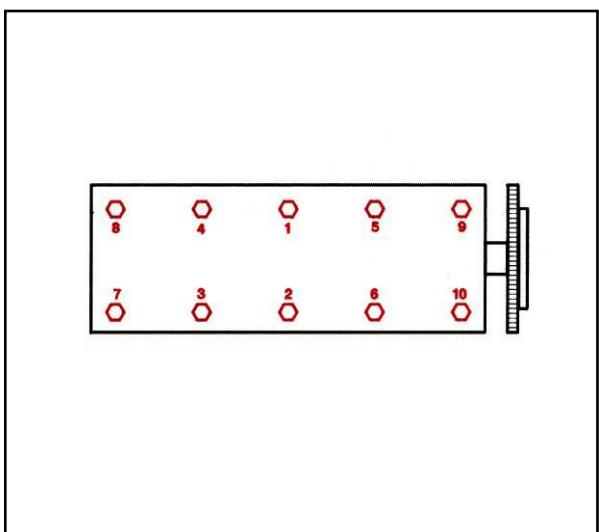
سرسیلندر را در محل خود قرار دهید و پیچ های سرسیلندر را ابتدا به روغن موtor آگشته نمایید و پیچ ها را به ترتیب ارائه شده است ، به روش حلزونی از وسط سرسیلندر به سمت خارج ، محکم کنید و سپس با استفاده از ابزار ذیل-آچار واسطه درجه ای (کد اختصاصی ۲۴۴۰۸۰۹)-پیچ ها رابه اندازه ۲۶۰ درجه محکم نمایید.
