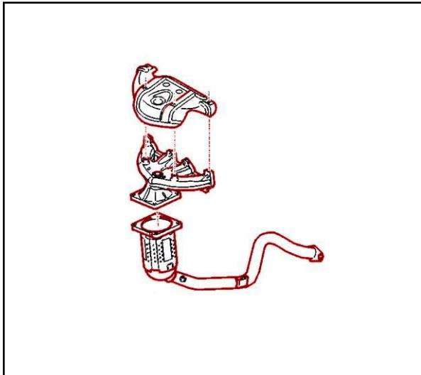
به منظور حفاظت از لوله های هیدرولیک فرمان ، بر روی منیفولد اگزوز ، محافظ حرارت گیر نصب شده است. کاتالیک کانورتور ، مستقیماً به زیر منیفولد اگزوز وصل شده است . برای حفاظت از فیلتر روغن نیز ، یک محافظ حرارت گیر دیگری نصب شده است.
