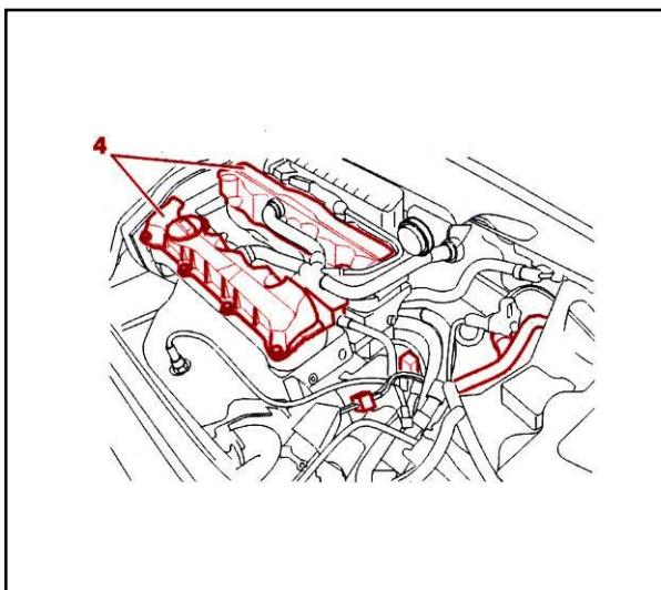
کویل را باز کنید و قالپاق سوپاپها (4) را باز کنید. دقیت کنید که پیچ های سرسیلندر را بطور حلقه ای از سمت بیرون به داخل ، باز کنید . با ثابت نگه داشتن میل سوپاپ توسط یک آچار تخت در نقطه A ، پیچ دنده میل سوپاپ را باز کنید .
