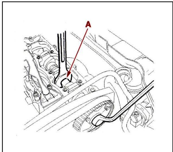
میل سوپاپ را با آچار تخت در نقطه A ثابت نگه داشته و پیچ آن را به اندازه (8) دکانیوتن متر سفت کنید .
