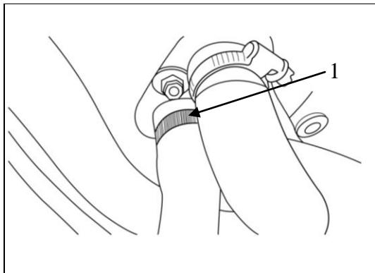
۱۳- بست مربوط به شیلنگ خروجی(۱) از رادیاتور بخاری به پشت ترموستات جدا نموده و شیلنگ را جدا نمایید.
