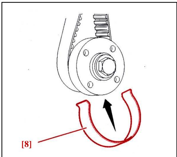
ابزار مخصوص [8] ( کد اختصاصی ۲۴۴۲۸۰۰۷ ) را روی پولی میل لنگ قرار دهید تا تسمه را سرجای خود نگهدارد .
