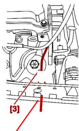
توسط ابزار مخصوص [3] (جزء کیت ابزار تعمیر موtor با کداختصاصی ۲۴۴۱۱۰۷) فلایویل را ثابت کنید.
