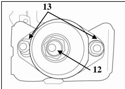
۱۶- دسته موتور روی گیربکس(۱۶) را با باز کردن پیچ وسط ضربه گیر(۱۲) و دو پیچ کنار(۱۳) و پیچهای دسته موتور (۱۱ و ۱۴ و ۱۵) باز نمایید.
