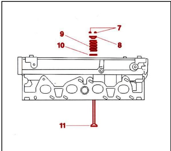
خار موشکی (7)، پولکی (8)، فنر سوپاپ (9)، واشر زیر فنر (10) و سوپاپ (11) را بیرون آورید.
