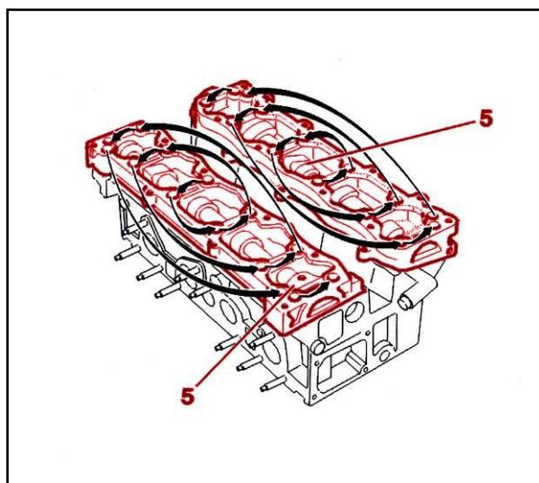
نکته : پیچهای اتصال کپه چدنی (5) میل بادامک رابه ترتیب از داخل به بیرون باز نمایید . به طوری که پیچها به اندازه چند میلیمتر از سطح تماسشان جدا شود. میل بادامکها را با ضرباتی که توسط چکش پلاستیکی به انتهای پولی میل بادامک اعمال می شود بیرون آورید. کپه چدنی میل بادامک و کاسه نمد لبه دار میل بادامک و میل بادامک را بیرون آورید .
