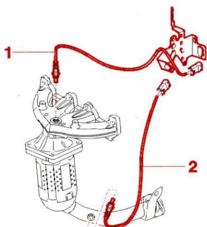
کانکتورهای الکتریکی مربوط به سنسورهای اکسیژن
