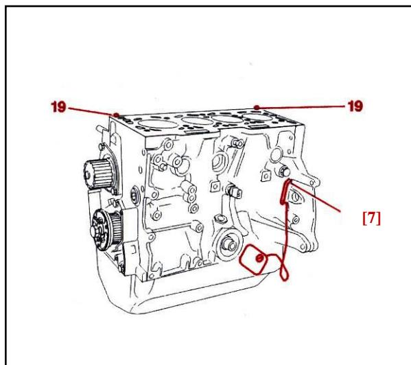
میل لنگ را بچرخانید تا ابزار مخصوص تایم میل لنگ [7] (جزء کیت ابزار با کد اختصاصی ۲۴۴۱۱۰۷) نصب گردد.
