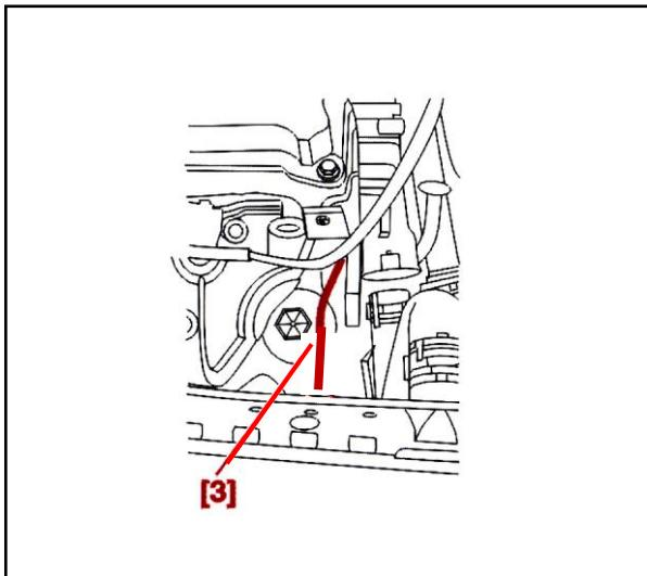
میل لنگ را با استفاده از ابزار مخصوص تایم میل لنگ [3] که در محل خود بر روی فلاکسیول ، نصب می شوند، تنظیم کنید . سپس ابزار مخصوص [3] (جزء کیت ابزار با کد اختصاصی ۲۴۴۱۱۰۷ ) را خارج کنید و میل لنگ  $\frac{1}{4}$  دور در جهت عکس گردش موتور بچرخانید.
