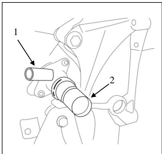
۱۴- شیلنگ انتقال آب از موتور به رادیاتور بخاری(۱) و شیلنگ ورودی آب از رادیاتور به موتور(۲) از سه راهی واقع در پشت موتور جدا شود (ترجیحاً رادیاتور جدا نمی شود ولی باید دقت شود ضربه نخورد)
