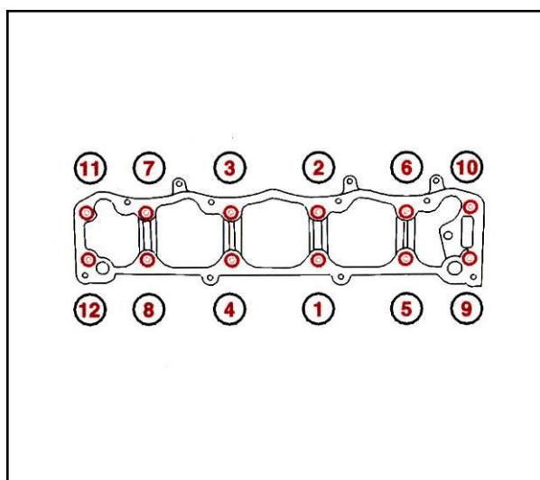
پیچ های سرسیلندر را به ترتیب نمایش داده شده در شکل از ۱ تا ۱۲ ببندید .
