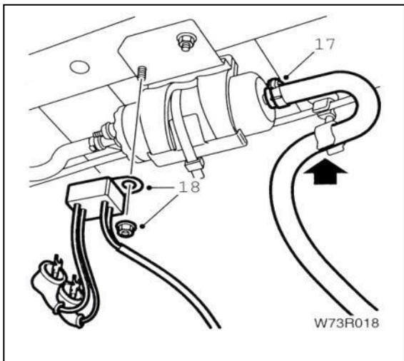
۱۷- اتصال شیلنگ بنزین به پمپ بنزین را جدا کرده و شیلنگ را از بست بدنه آزاد کنید.
