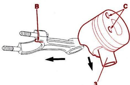
نکته : در زمان جا زدن گزن پین (3) در داخل پیستون در صورت تعویض نشدن قطعات ، آنها را جابجا نبندید.
