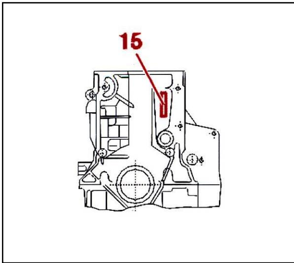
برای استفاده از روش جدولی ، می بایست از بارکد یا علائم حک شده بر روی بلوك سيلندر (15) نيز استفاده کنيد .
