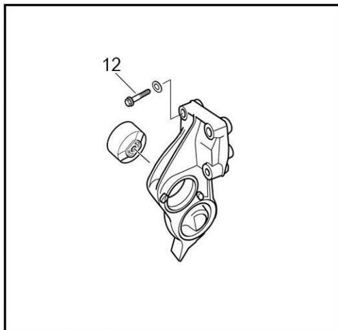
۱۷- دسته موتور پایین را نیز با باز کردن پیچهای(۱۲) آن از موتور و رام جدا نمایید.
