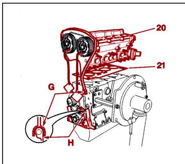
واشر سرسیلندر (21) را نصب نمایید دقیق کنید که کلمه Top به سمت بالا باشد سپس سرسیلندر (20) را نصب کنید.
