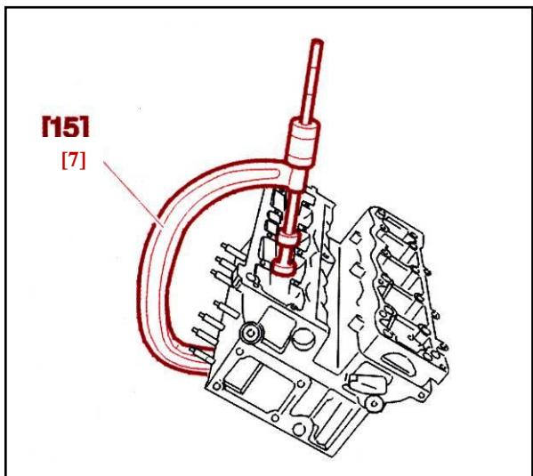
توسط سوپاپ جمع کن [7] (ابزار با اختصاصی ۲۴۴۱۶۰۱۳) سوپاپها را خارج نمایید.
