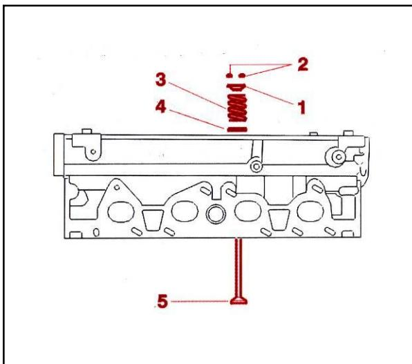
توسط ابزار مخصوص [7] (سوپاپ جمع کن با کد اختصاصی ۲۴۴۱۶۰۱۳) ، سوپاپ(5) ، واشر زیر فنر سوپاپ (4) ، فنر سوپاپ (3) ، پولکی (1) و خار موشکی (2) را نصب نمایید .
