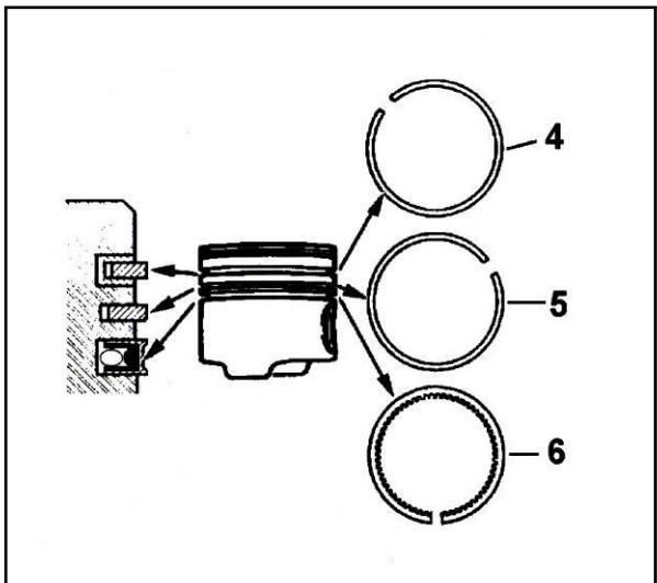
رینگها را مطابق شکل با ابزار رینگ جازن ، نصب نمایید:
