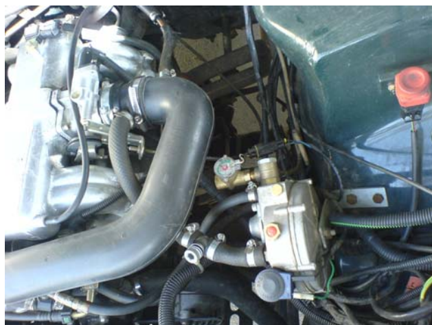
محل نصب رگلاتور در خودروی پیکان کاربراتوری
