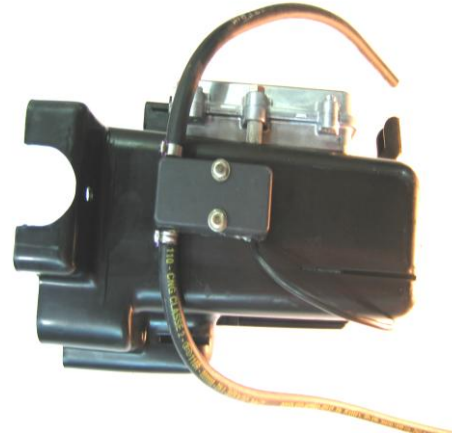
نصب سنسور سنسور فشار-خلاء روی جعبه ECU
