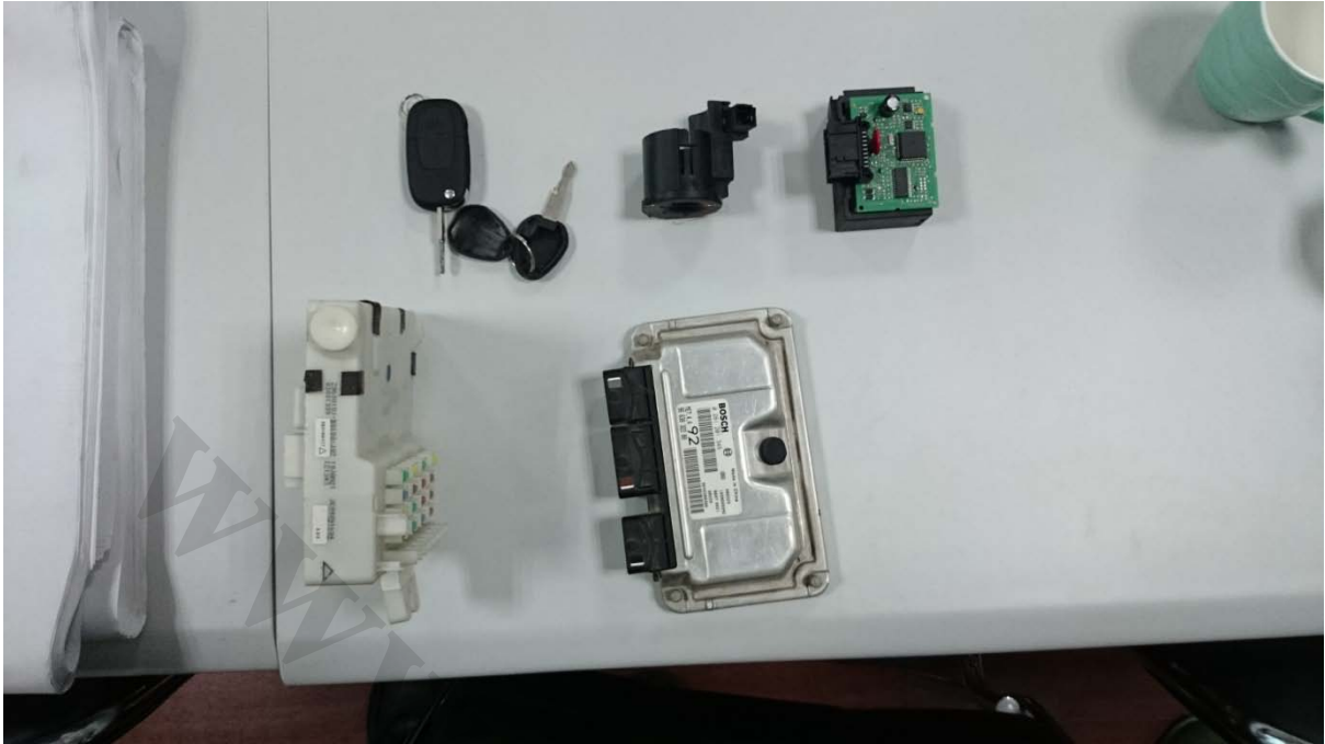
( کنترل یونیت موتور، ایموبیلایزر و سیستم انشعاب برق داخل اتاق )
