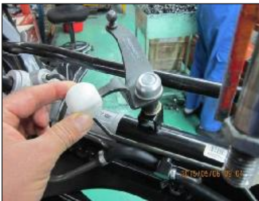
محل درگیری کانال بخاری با لیور اهرم
