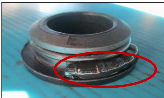
نحوه و محل چسب زنی درپوش کورکن سنسور کیلومترشمار
