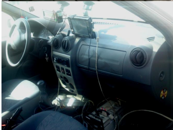
شکل ۱- خودرو تحت آزمایش مجهز شده به دستگاه‌های اندازه‌گیری
