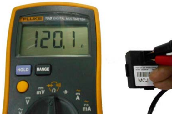
شکل 2-7 روش اندازه گیری مقاومت شبکه های CAN
