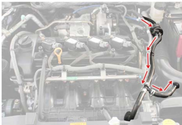
شکل 4-5 عملکرد سیستم کنترل بخارات بنزین در شرایط فعال بودن توربوشارژ
