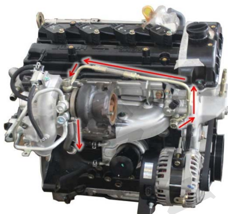
شکل 3-19 مدار روغن کاری سیستم
