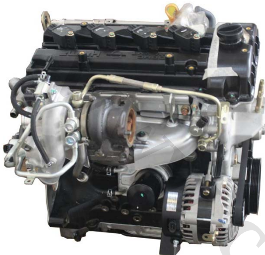
شکل 2-3 تغییرات ایجاد شده در ساختار خارجی موتور 1.8
