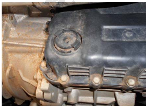
شکل 5-6 پیچ مربوط به بازدید روغن
