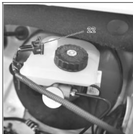
کانکتور سنسور سطح روغن ترمز (۲۲) را جدا کنید.
