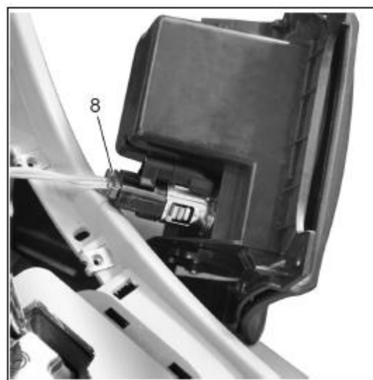
بیرون کشیدن فنک و جاسیگاری برای آزاد کردن اتصال فیش فنک (۸)
