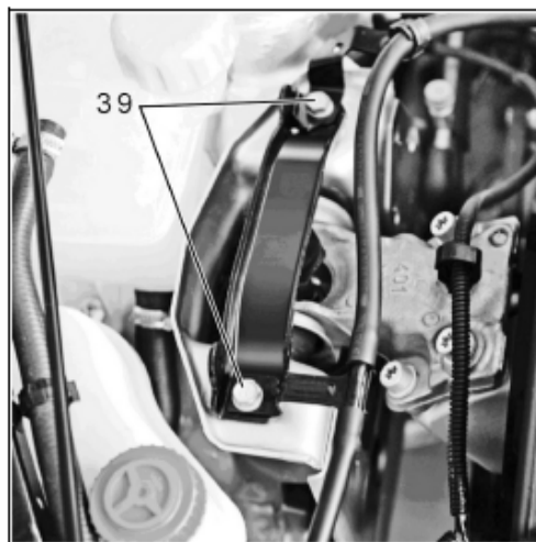
پیچ های تکیه گاه محدود کننده دسته موتور را باز نمایید ( ۳۹ )
