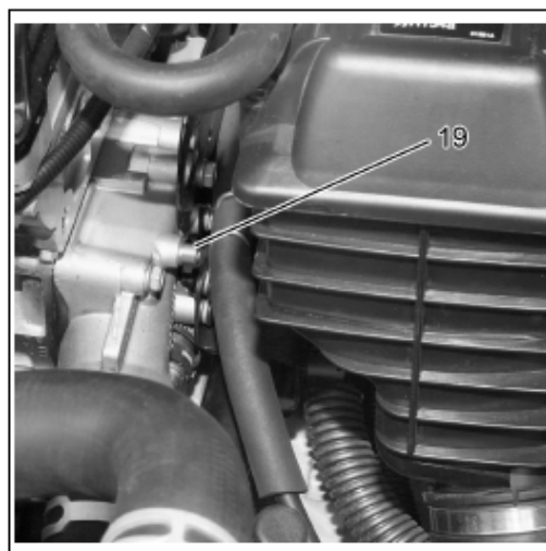
پیچ هواگیری (۱۹) را نیم دور باز نمایید.
