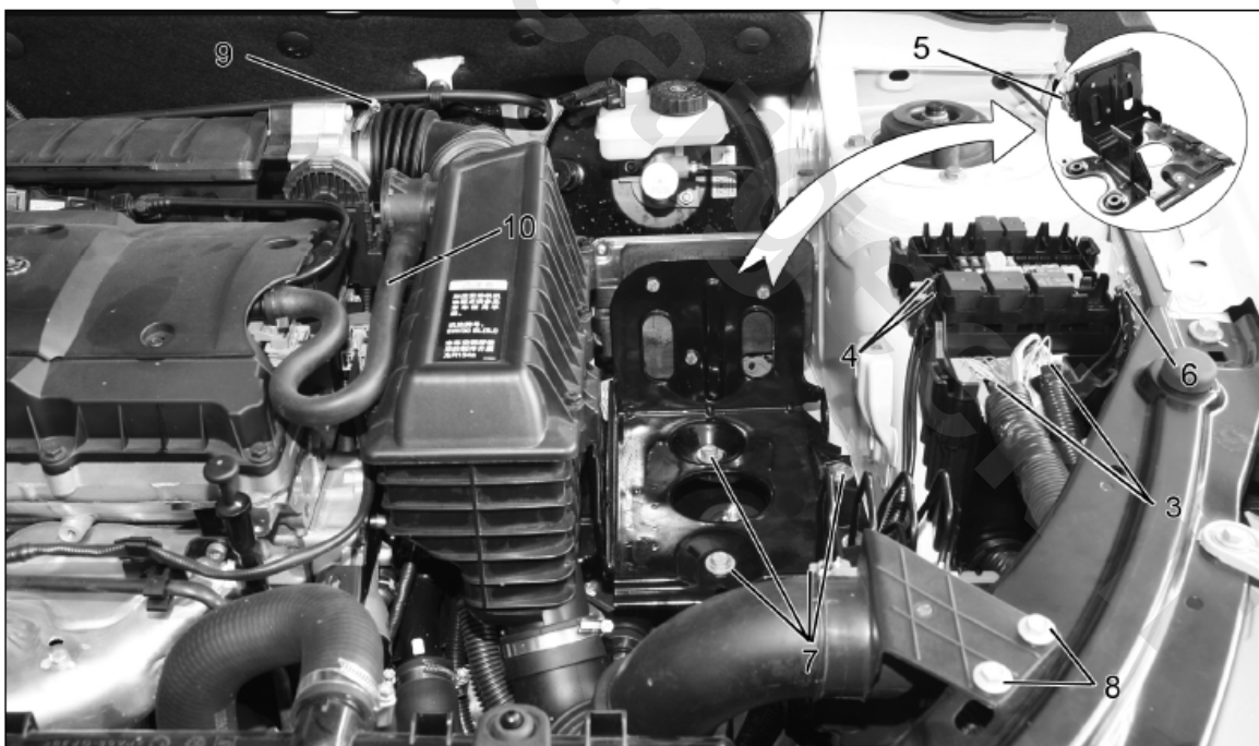
درپوش محافظ جعبه فیوز را باز کرده و کانکتور دسته سیم موتور (۳) و دسته سیم تغذیه موتور (۴) را جدا نمایید.
