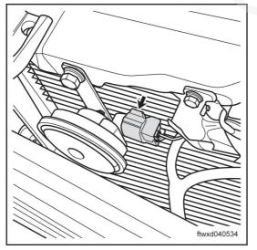
(c) (d) Disconnect the connector A018 of bass horn.
