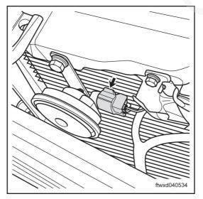
(c) (d) Disconnect the connector A018 of bass horn.
