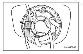
(C) (d) Disconnect the left front fog lamp connector A016.
