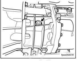
3. Unscrew the gearbox filler bolt.
