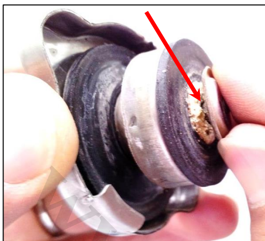
شکل شماره (۷) رسوب گرفتگی در سوپاپ فشار منفی
