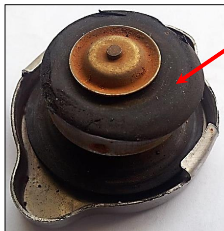
شکل شماره (۶) دفرمگی واشر لاستیکی
