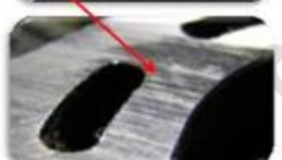
سطح سیلندر دارای خط و خش و غیر قابل قبول
