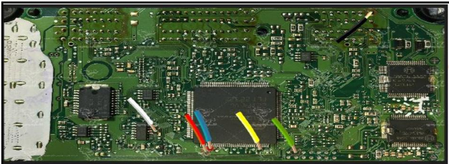
نمای کلی اتصال سیم های فلت رنگی به ایسیو بوش 7.4.5
