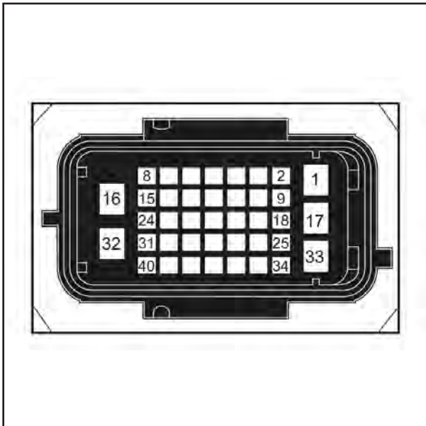
X03: اتصال دسته سیم موتور به کانکتور دسته سیم محفظه موتور
