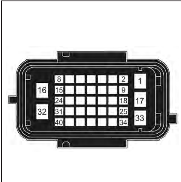
X03: اتصال دسته سیم محفظه موتور به کانکتور دسته سیم موتور
