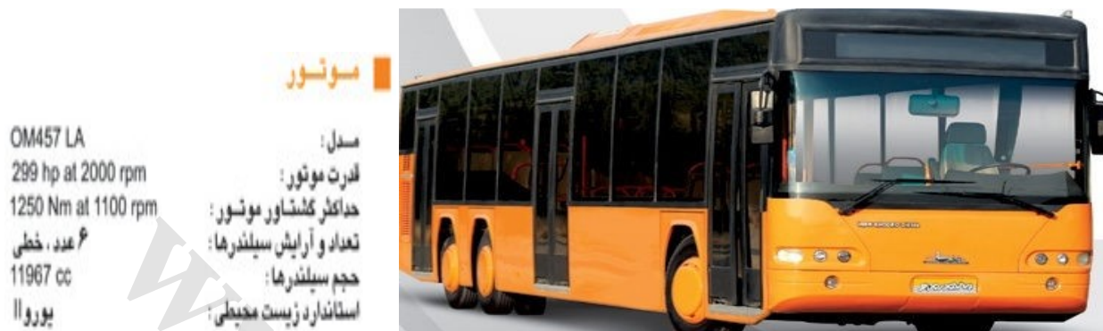
شکل ۳.۵ اتوبوس مدل MEGATRANS و مشخصات موتور آن
