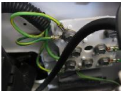
۳-صفحه اتصالات منفی سیم کشی موتور
