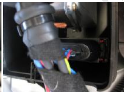
۲-محل قرار گیری یونیت فن (زیر چراغ جلو سمت راننده)
