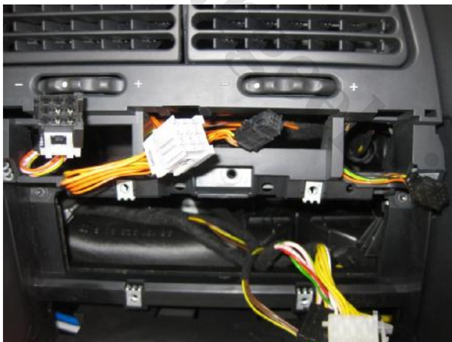
نمای از پشت: کلید قفل کن شیشه بالابر - کلید AC - فلاشر - ساعت و دماسنج - سنسور کولر اتوماتیک
