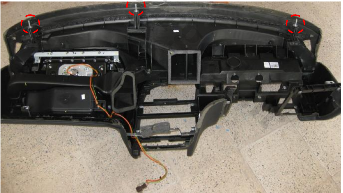
داشبورد خودرو زانتیا : در اینجا مشاهده می کنید که فقط سیمهای مربوط به ایربگ شاگرد به همراه داشبورد بیرون آمده
