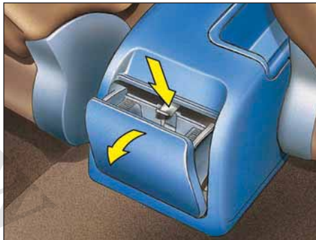
جاسیگار بها جهت خالی کردن آن، زبانه قفلی را که در زیر آن قرار دارد کشیده و آن را بلند کرده و به طرف خود بکشید. نصب جاسیگاری جاسیگاری را در جای خود قرار داده و به طور کامل به داخل فشار دهید. در روی کنسول عقب در را پایین بیاورید. جهت خالی کردن، جاسیگاری را به طرف خود کشیده و همزمان زبانه قفلی آن را به پایین فشار دهید.
