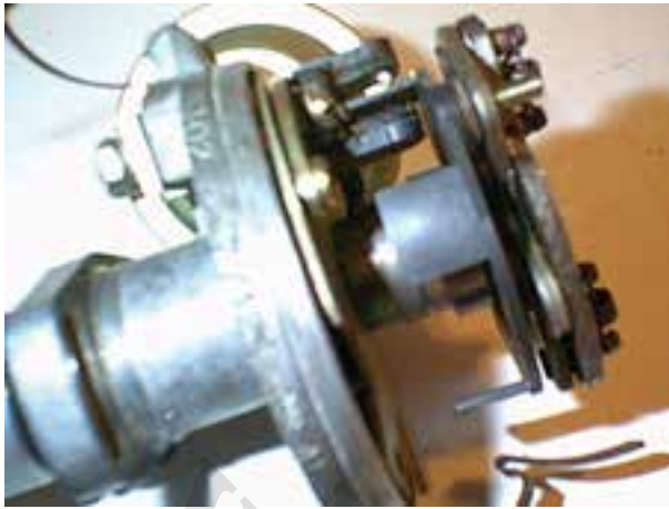
شکل ۷۳-۱۰- دلکوی الکترونیکی با حسگر اثرهال
