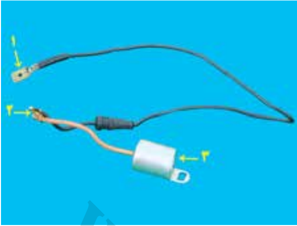
۱- سیم متصل به منفی کوئل ۲- محل اتصال به پلاتین ۳- خازن
