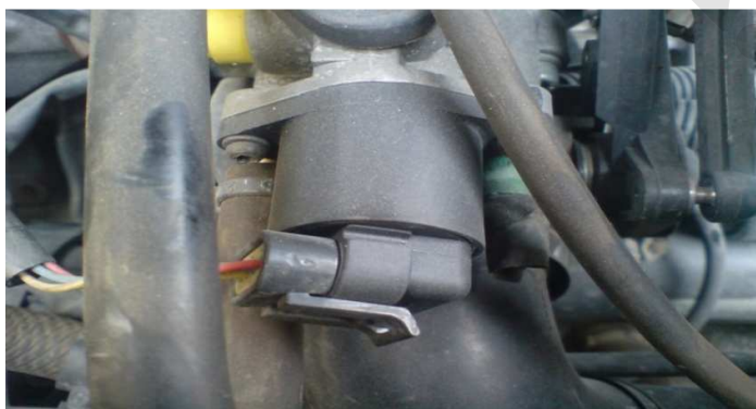
شکل (۳-۲۶) عملگر استپر موتور
