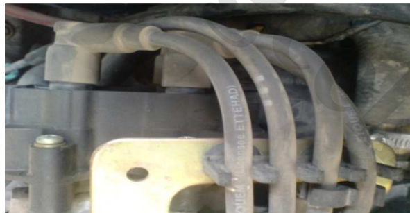
شکل (۲۲-۳) عملگر کوئل دوبل
