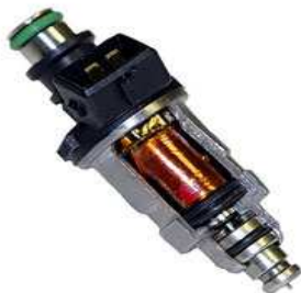
شکل (۳-۲۸) عملگر انژکتور
