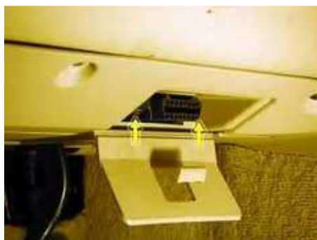
شکل (۳-۳۶) کانکتور عیب یاب
