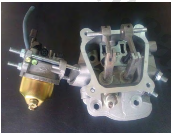
شکل ۸: مکانیزم ساخته و نصب شده بر روی سر سیلندر برای تبدیل حرکت دوارانی استپر موتور به حرکت به خطی
