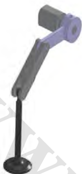
شکل ۷: مکانیزم طراحی شده برای تبدیل حرکت دوارانی استپر موتور به حرکت به خطی
