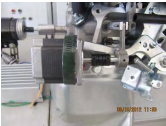
شکل ۹: استپر موتور کوپل شده به مکانیزم ساخته شده بر روی موتور
