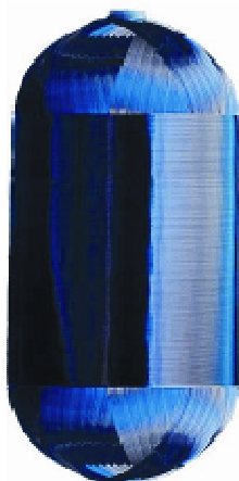
شکل ۷-۹: طرح شماتیکی از الیاف پیچی کامپوزیتی به دور لایه آستری
