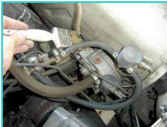
تست نشتی اتصالات گاز فشار قوی
