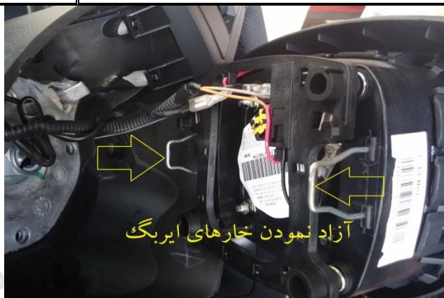
شکل دو : آزاد نمودن خارهای ایربگ
