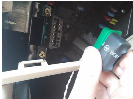
شکل نه : اتصال کانکتور سبز رنگ به OBD2 خودرو
