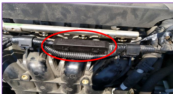
در H300 فیوز دینام قسمت بالای موتور کنار ریل سوخت قرار دارد
