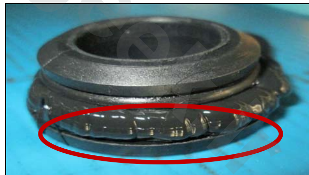
نحوه و محل چسب زنی درپوش کورکن سنسور کیلومترشمار
