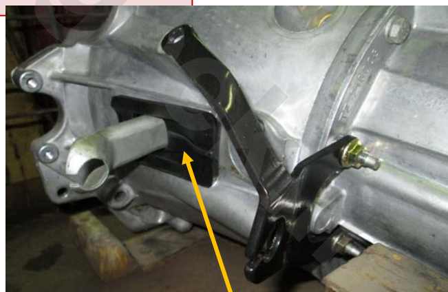
گردگیر لاستیکی در محل خروج دوشاخه کلاچ ۱۵۶۰۱۰۱۰
