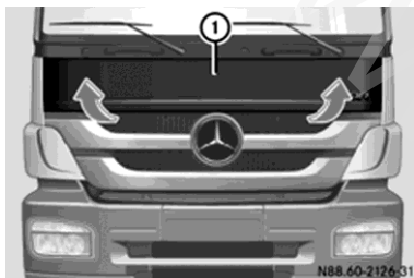
درب سرویس و نگهداری جلوی خودرو بدون پایه نگهدارنده گازی
