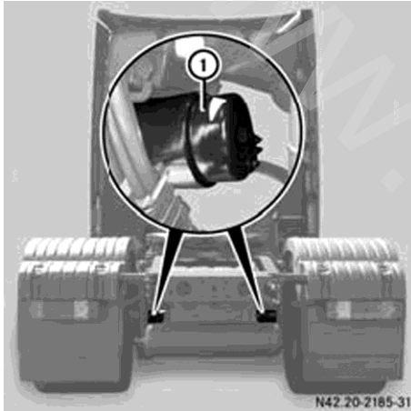
محل قرارگیری سیلندرهای (بوسترهای) فنری ترمز پارک (مثال: خودرو کشنده تریلر)
