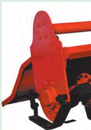
شکل ۲۴-۱. کفش تنظیم عمق
