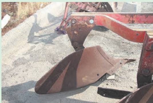
شکل ۲۱-۱. پین بریده شده در گاواهن
