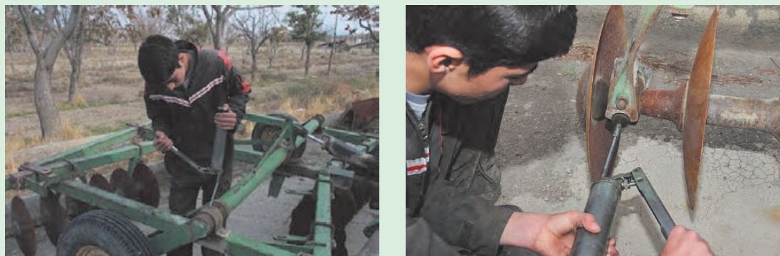
شکل ۱۶-۲. گریس کاری دیسک
