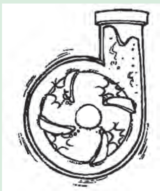
شکل ۲۹-۵. کایتاسیون در پروانه پمپ
