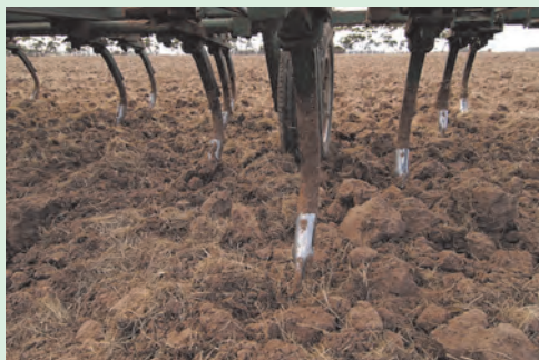
شکل ۴۷-۱. زمین شخم خورده به وسیله گاوآهن قلمی
