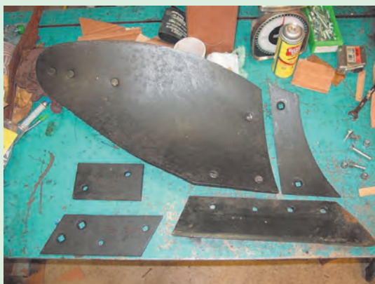
شکل ۲۰-۱. چیدمان اجزای بازشده خیش در کنار یکدیگر
