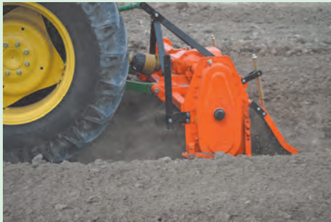
شکل ۴۸-۱. تاثیر درپوش بر خرد شدن خاک
