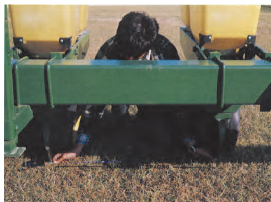
شکل ۲۵-۳. جابجایی ردیف‌های کاشت در ردیف کار
