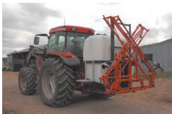
شکل ۳۰-۴. سم پاش بوم دار در دو حالت کار و حمل و نقل
