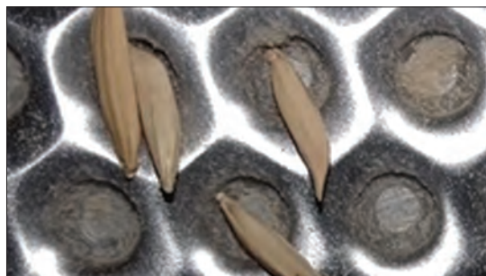
شکل ۱۶- قرار گرفتن دانه‌ها در سوراخ‌های استوانه حفره‌دار
