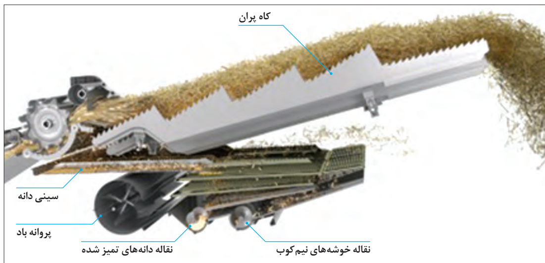
شکل ۱۹- مسیر حرکت محصول درو شده در واحدهای کوبنده، جداکننده و تمیزکننده
