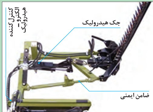
شکل ۱۷- دروگر شانه‌ای با سیستم محرک ارتعاشی
