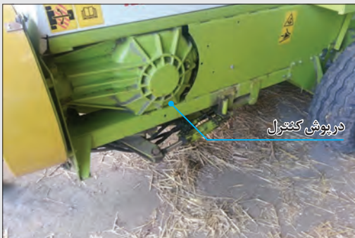
شکل ۸۴- جعبه دنده بسته‌بند
