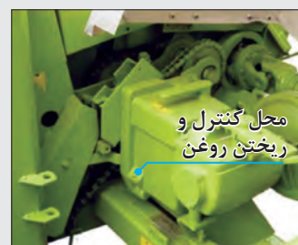
شکل ۴۵- جعبه دنده باردهی غلتک‌های تغذیه
