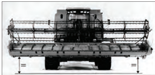
شکل ۳۷- اندازه‌گیری تراز بودن پلاتفرم
