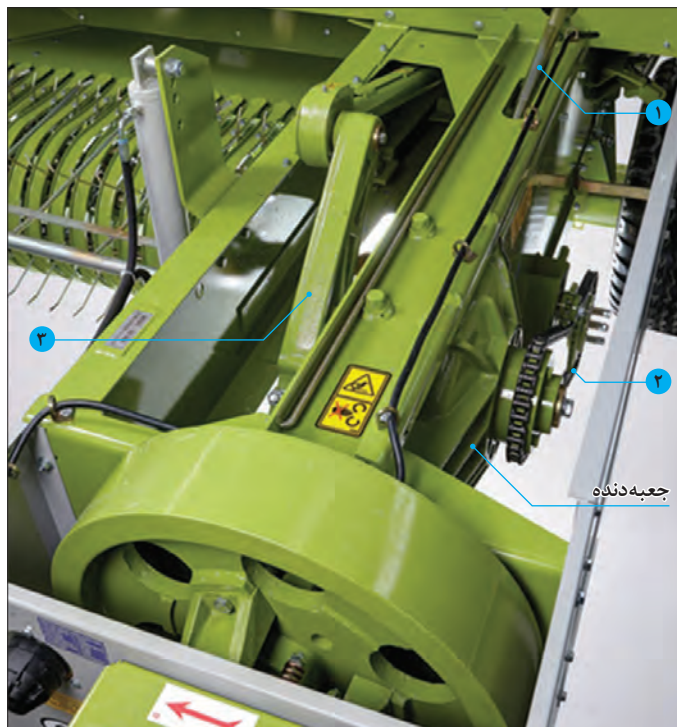
شکل ۸۲- مسیر انتقال توان در بسته‌بند
