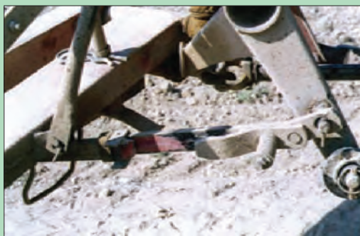
شکل ۲۰- ضامن ایمنی عمل کرده در برخورد با مانع
