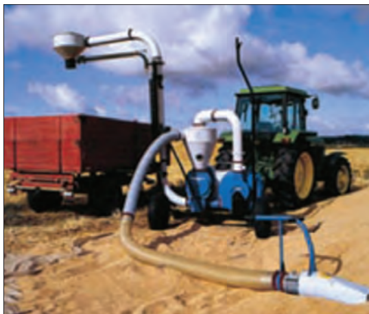
شکل ۲۹- نقاله بادی و طرز کار آن
