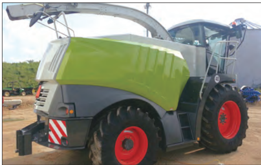
شکل ۳۶- نشیمنگاه لوله تخلیه
