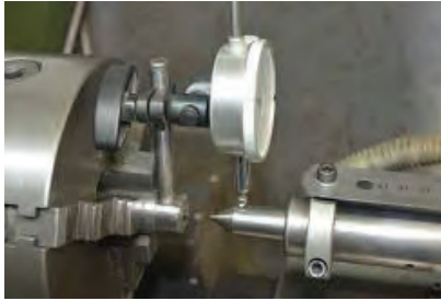
شکل ۳۰- اندازه‌گیری انحراف مرغک
