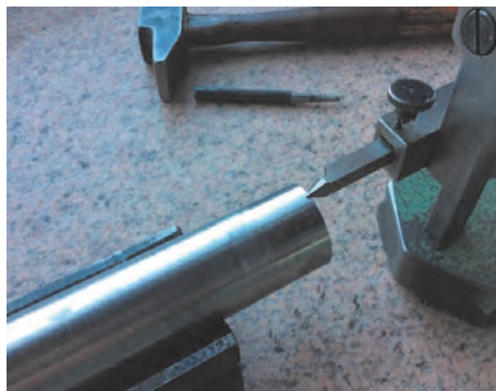
شکل ۲۱ - خطکشی و تعیین مراکز لنگ
