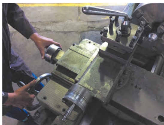
شکل ۱۰- حرکت همزمان سوپرت‌های دستگاه
