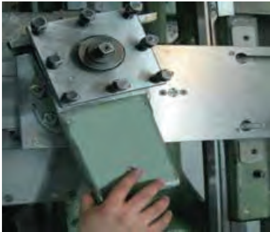
شکل ۱۲- مخروط تراشی به روش انحراف سوپرت بالایی
