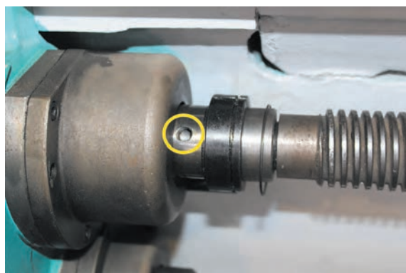
شکل ۳۴- پین فیوز مکانیکی
