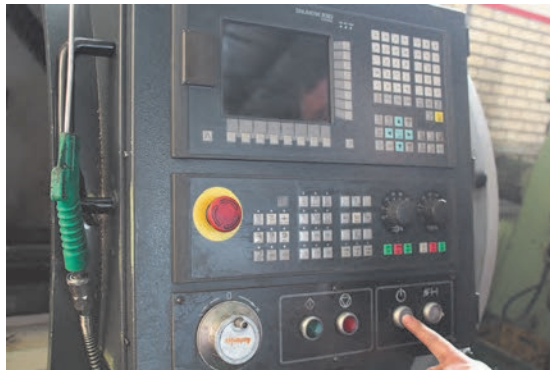
شکل ۱۹- روشن کردن سیستم هیدرولیک دستگاه
