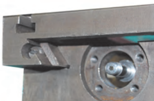
پیچ تکیه‌گاهی انتهای گوه محور عرضی شکل ۱۲- سوپرت عرضی
