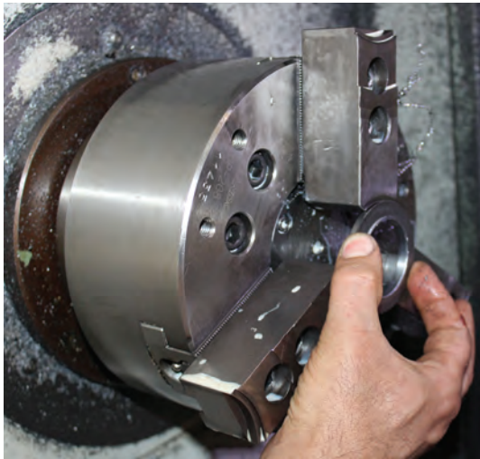
شکل ۳۰- بستن قطعه کار روی سه نظام
