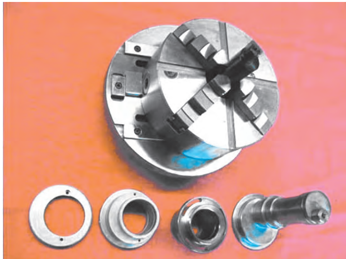
شکل ۱۷- سه‌نظام قابل تنظیم و قطعات تولید شده
