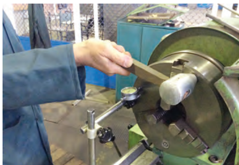
شکل ۷- اندازه‌گیری میزان لقی محوری
