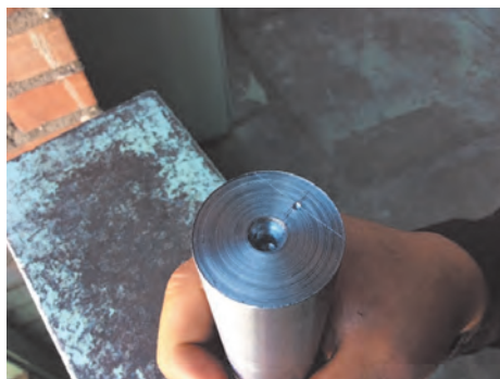
شکل ۲۲ - سنبه‌نشان‌زدن پیشانی قطعه کار
