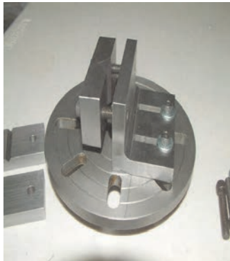
شکل ۱۹ - فیکسچرهای مخصوص لنگ تراشی
