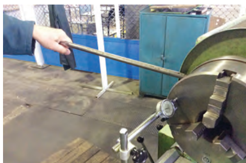
شکل ۷- اندازه‌گیری میزان لقی محوری
