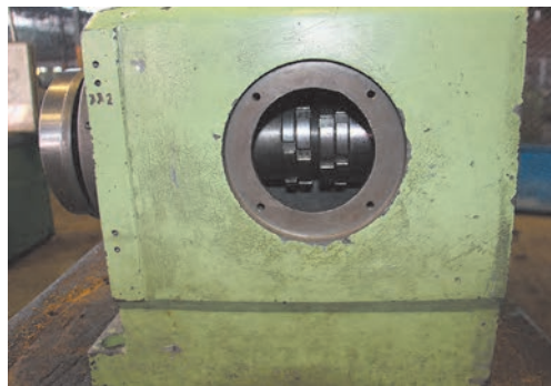
شکل ۵- سفت کردن یاتاقان جلوی دستگاه
