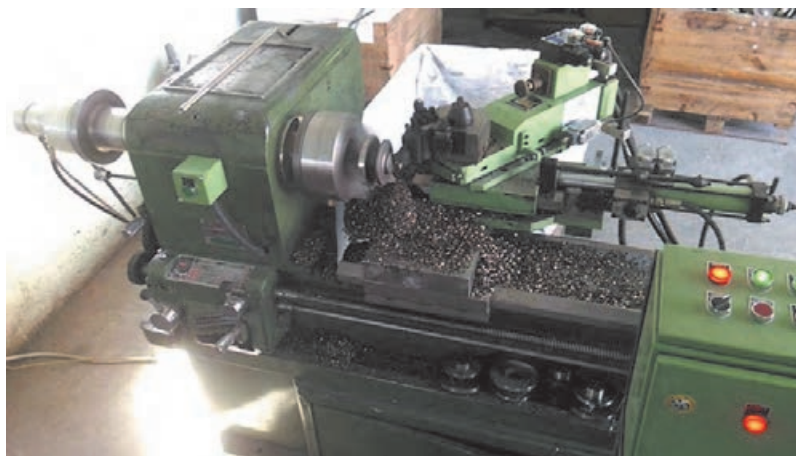
شکل ۷- عملیات کپی تراشی
