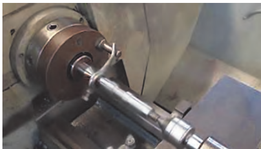
شکل ۲۰ - لنگ تراشی بین دو مرغک
