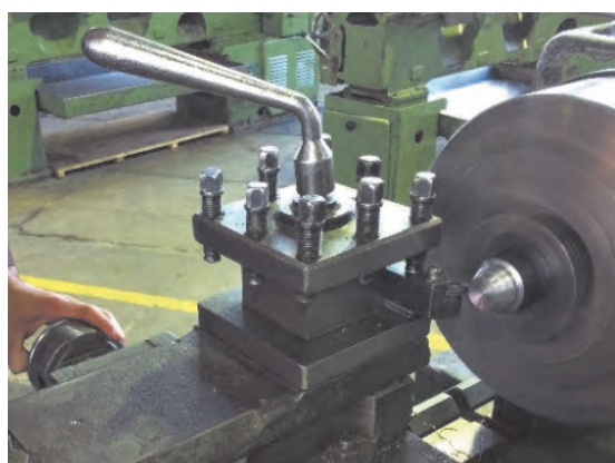
شکل ۱۰- حرکت همزمان سوپرت‌های دستگاه
