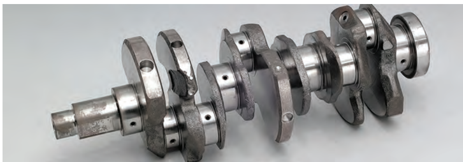
شکل ۱۶- میل لنگ آهنگری شده-محصول نهایی
