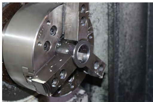
شکل ۹- استقرار سه‌نظام روی مجموعه محور اصلی
