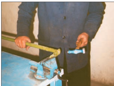
شکل ۱۵- صاف کردن پایه بلبرینگ
