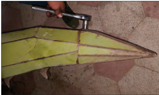
شکل ۲۲- تعویض کلگی دماغه
