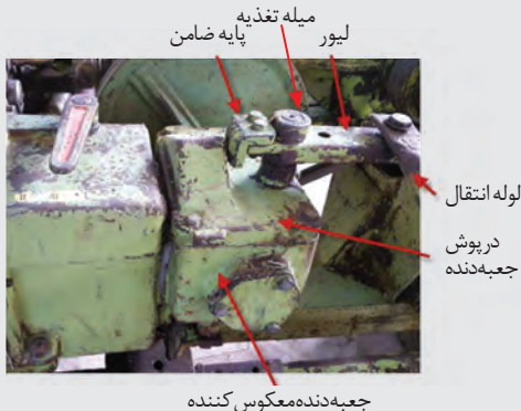
شکل ۹- قطعات بیرونی جعبه‌دنده معکوس کننده
