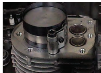
شکل ۳۲- جا زدن پیستون
