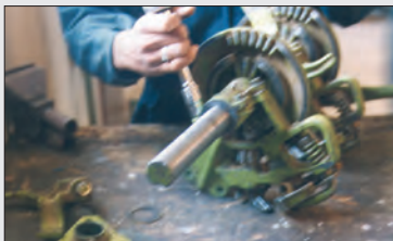
شکل ۷۶- پیاده کردن محور گرهزن و اجزای آن
