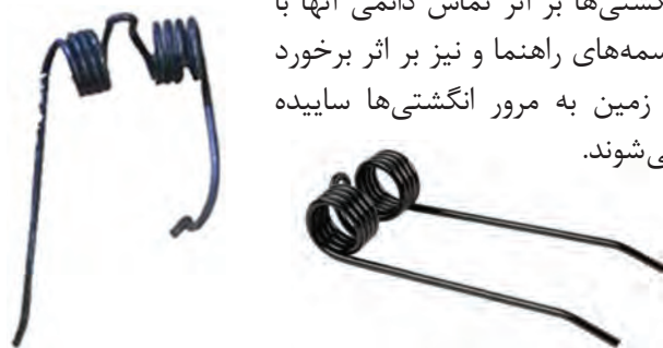
شکل ۴- تفاوت انگشتی سالم و انگشتی معیوب
