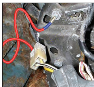
شکل ۲۷- آزمایش مدار لامپ شارژ
