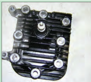
۸- سر سیلندر را پیاده کرده و پیچ های آن را به ترتیب در محل رسم شده روی کارتن بچینید.
