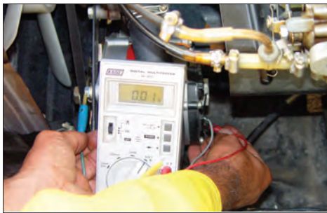
شکل ۳۰- آزمایش اجزای داخلی آلترناتور
