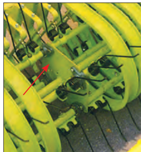
شکل ۱۶- یاتاقان محور انگشتی و محل نصب آن
