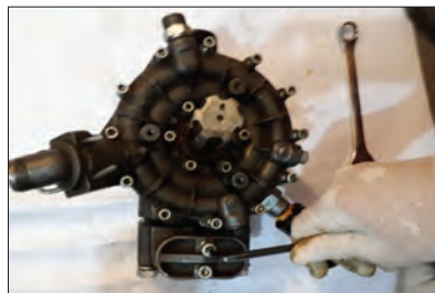
شکل ۴۸ - باز کردن درپوش سوپاپ ها
