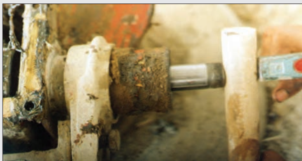
شکل ۲۳- خارج کردن محور ورودی
