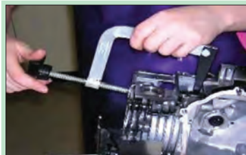
۱۷- دسته سوپاپ جمع کن را فشار دهید یا پیچ آن را بچرخانید تا فنر سوپاپ جمع شود.
