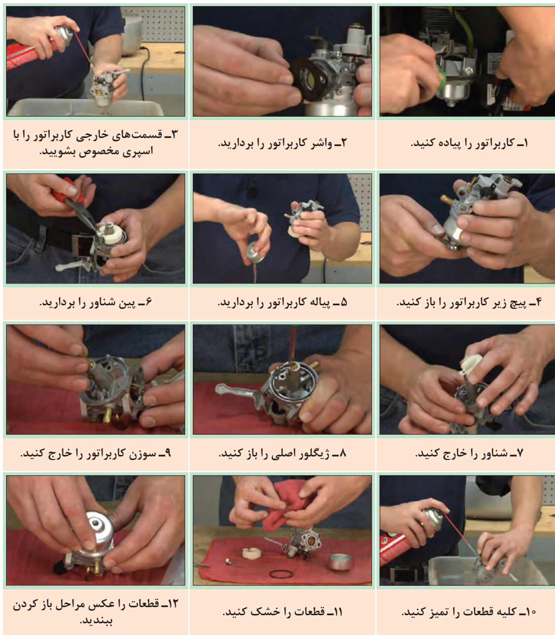
شکل ۲۵- باز کردن و تمیز کردن قطعات کاربراتور
