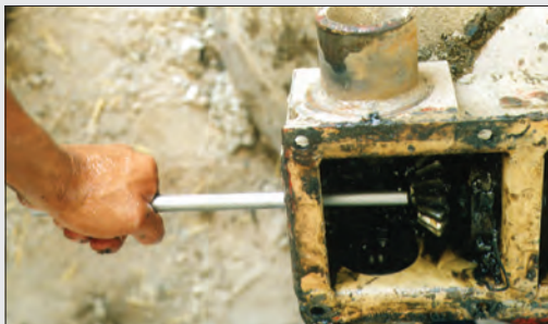
شکل ۲۷- ضربه از طرف درپوش توسط میله
