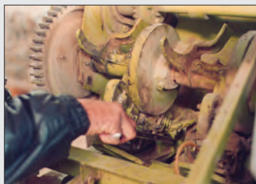
شکل ۴۴- باز کردن کفشک گرهزن
