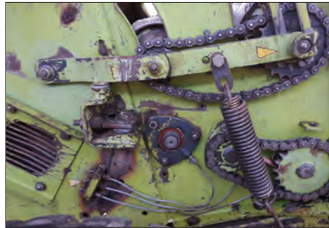
شکل ۳۷- فنر شناوری غلتک‌های بالایی
