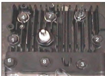
شکل ۳۴- ترتیب بستن پیچ‌های سرسیلندر
