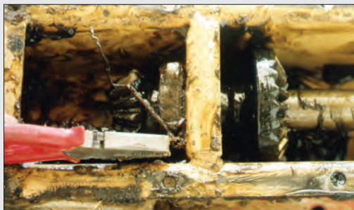
شکل ۲۶- باز کردن سیم مفتولی
