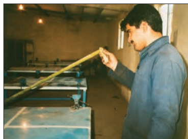
شکل ۱۰- آزمایش کجی محور انگشتی
