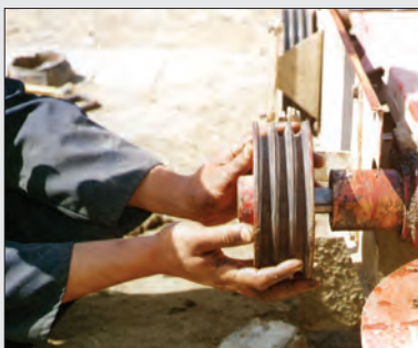
شکل ۱۱- برداشتن چرخ تسمه
