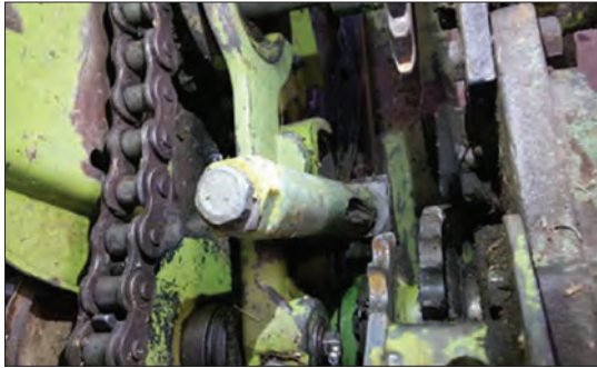
شکل ۴۳- اهرم و پیچ تنظیم تیغه ثابت
