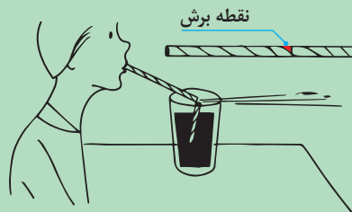
شکل ۹- آزمایش تأثیر اختلاف فشار دو سر یک لوله و مکش ایجاد شده در آن
