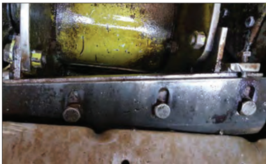
شکل ۴۴- پیچ و شیارهای رگلاژ تیغه متحرک
