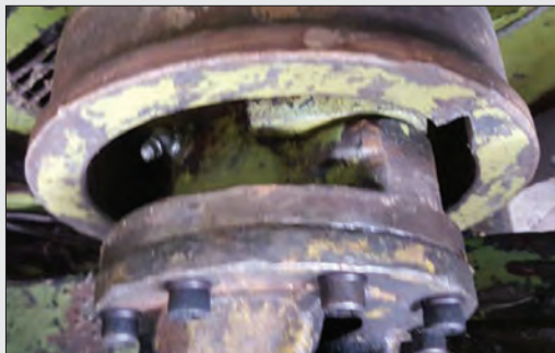
شکل ۴۸- پیچ‌های اتصال کلاچ به یوک چهارشاخه گاردان
