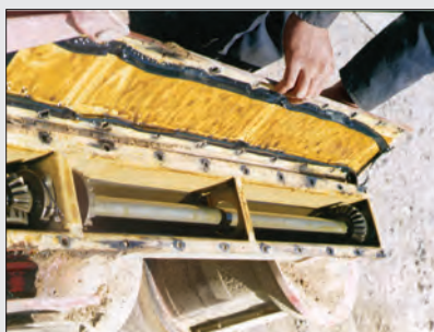
شکل ۲۱- برداشتن سرپوش جعبه دنده
